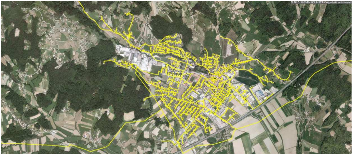
Slika 3: Trasa plinovoda in toplovoda v občini Slovenska Bistrica
